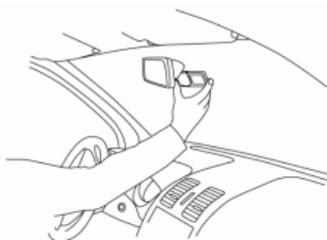
В. Обезжирьте участок на ветровом стекле, куда будет установлен Транспондер. Удостоверьтесь, что данный участок вытерт насухо. При необходимости дополнительно протрите насухо, а также прогрейте ветровое стекло в случае, если температура ниже  $-10^{\circ}\text{C}$ .
